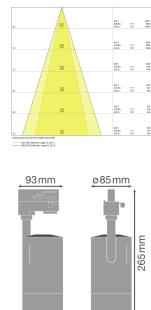
**Technische Daten Ledvance LED Schienenstrahler D85 Schwarz 25W 1500lm 15-55D - 830 | Mechanical Zoom - Dimmbar**
