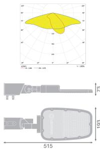
**Technische Daten Ledvance LED-Scheinwerfer Area mittel Grau 65W 8450lm 160x58D - 730 | IP66 - Symmetrisch**
