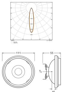
**Technische Daten Ledvance LED spot G53 AR111 11.7W 450lm 40D - 930 | Höchste Farbwiedergabe - Dimmbar - Ersatz für 50W**
