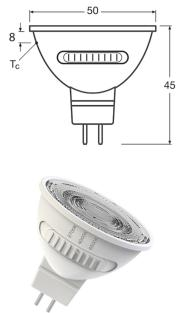
**Technische Daten Osram LED Superstar Reflektor Spot GU5.3 MR16 5.6W 550lm 45D - 827 | Ersatz Für 45W**
