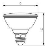
**Technische Daten Philips Master Value LED Glühbirne Reflektor E27 PAR30 9.5W 820lm 25D - 940 Kaltweiß | Höchste Farbwiedergabe - Dimmbar - Ersatz für 75W**
