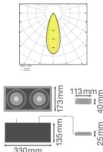
**Caractéristiques Ledvance Spot LED Carré Multi inclinable Noir-Blanc 2x30W 5400lm 38D - 830 Blanc Chaud | Diamètre 320x160mm**
