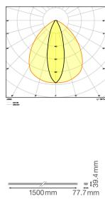
**Caractéristiques Ledvance LED Rail de fixation suspendu Trusys Flex Claire 50W 8600lm 30D - 840 Blanc Froid | Éclairage de secours 3 heures**
