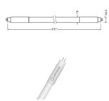
Caractéristiques Ledvance Tube LED T5 Value Short (HF) High Efficiency 7W 850lm - 840 | 52cm - Remplacement 13W
