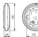
**Caractéristiques Philips Hublot LED Ledinaire WL070V Blanc 20.9W 1700lm - 830 | 285mm - IP65 - DéTECTEUR de mouvement et de lumière**
